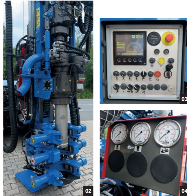
01 KR 708-3GW 02 Klemm- und Brechvorrichtung // clamping and breaking device 03 Maschinenüberwachung // machine monitoring 04 Manometerbox // manometer box
